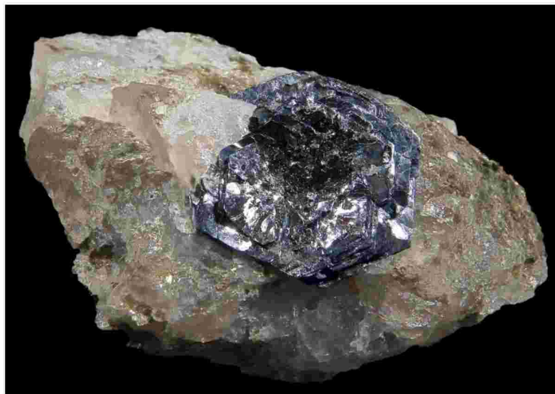
1.2 сурет – Алтыбұрышты қабатты құрылым табиғи молибденит ( \text{MoS}_2 )
