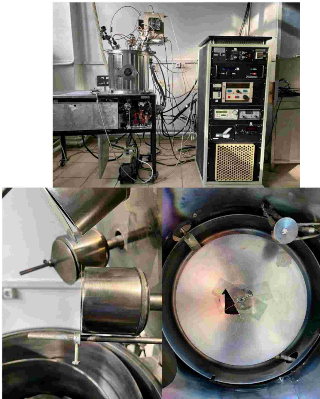
2.8 сурет – ARC2000 магнетронды тұндыру құрылғысы
