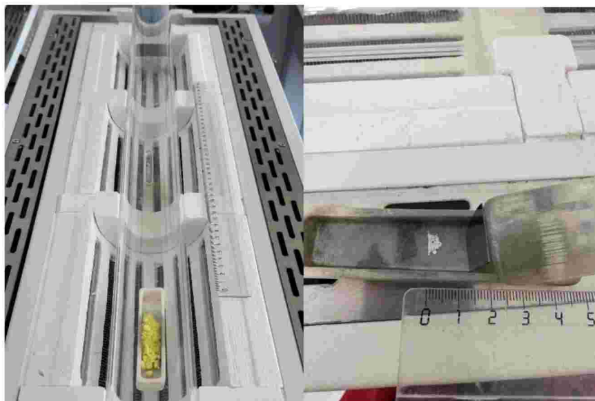
2.3 сурет – Ұнтақ күйіндегі реагенттер кварц ыдыстарында
