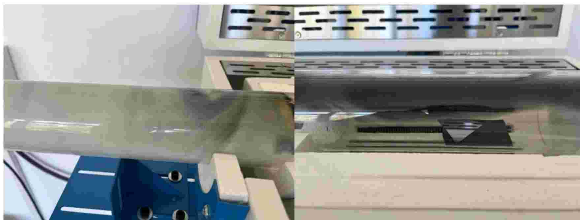
2.6 сурет – Сульфуризация процесінен кейінгі пеш құбырының көрінісі
